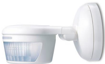
Ideal für Parkgaragen ist der Busch-Wächter® 220 ProfessionalLINE. Er erfasst Bewegungen im Radius von 16 Metern und schaltet dann das Licht automatisch ein. Auch ohne Netzspannung lässt er sich am geeignetsten Punkt im Raum installieren. Denn er kann mit Batterie betrieben werden. Große Areale lassen sich durch mehrere Sensoren überwachen. Ein Aktor in der Nähe der Leuchte empfängt dann von allen Sensoren das Signal.
